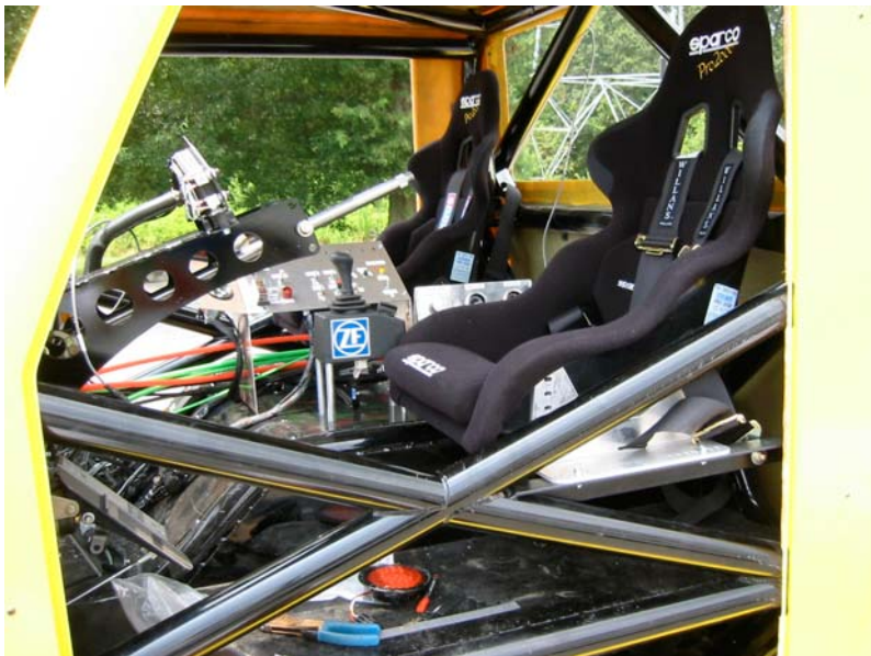
Der Innenraum kurz vor der Fertigstellung. Deutlich zu erkennen das Display der Datenaufzeichnung auf der Lenksäule, das Schalterpanel und der elektronische Schaltknüppel.
